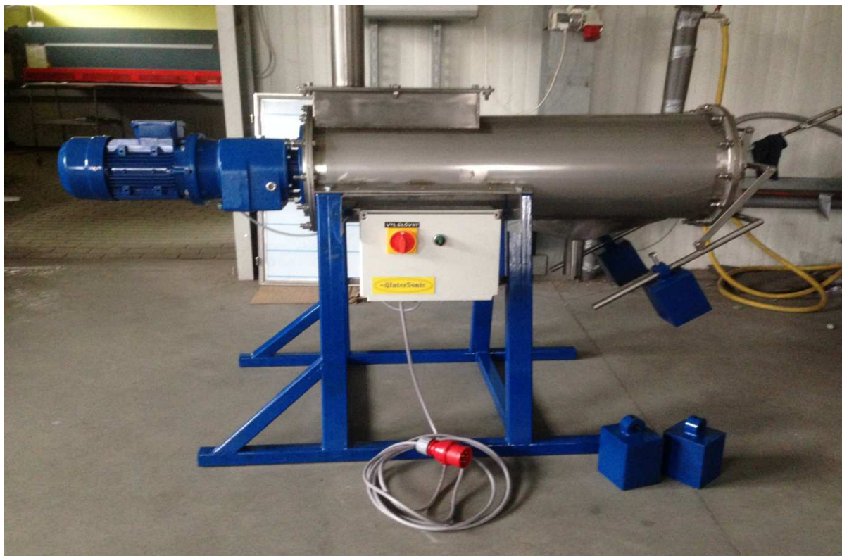
Prototyp separatora śrubowego. Wydajność 3 m 3 /h.
